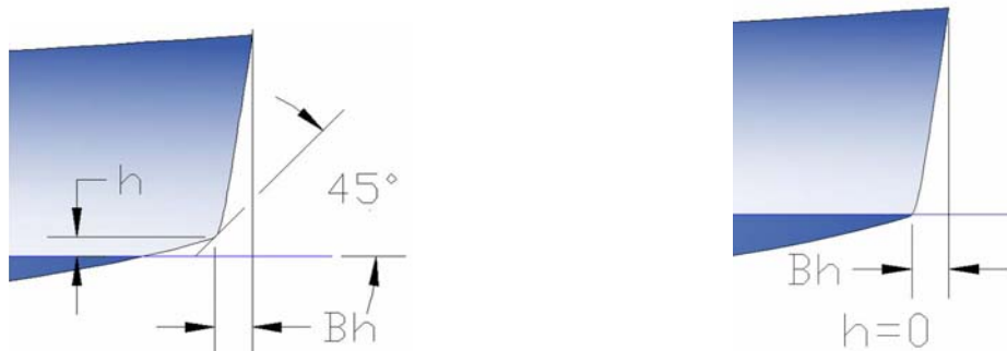
Imagen 10. Altura del lanzamiento de proa, "h"
